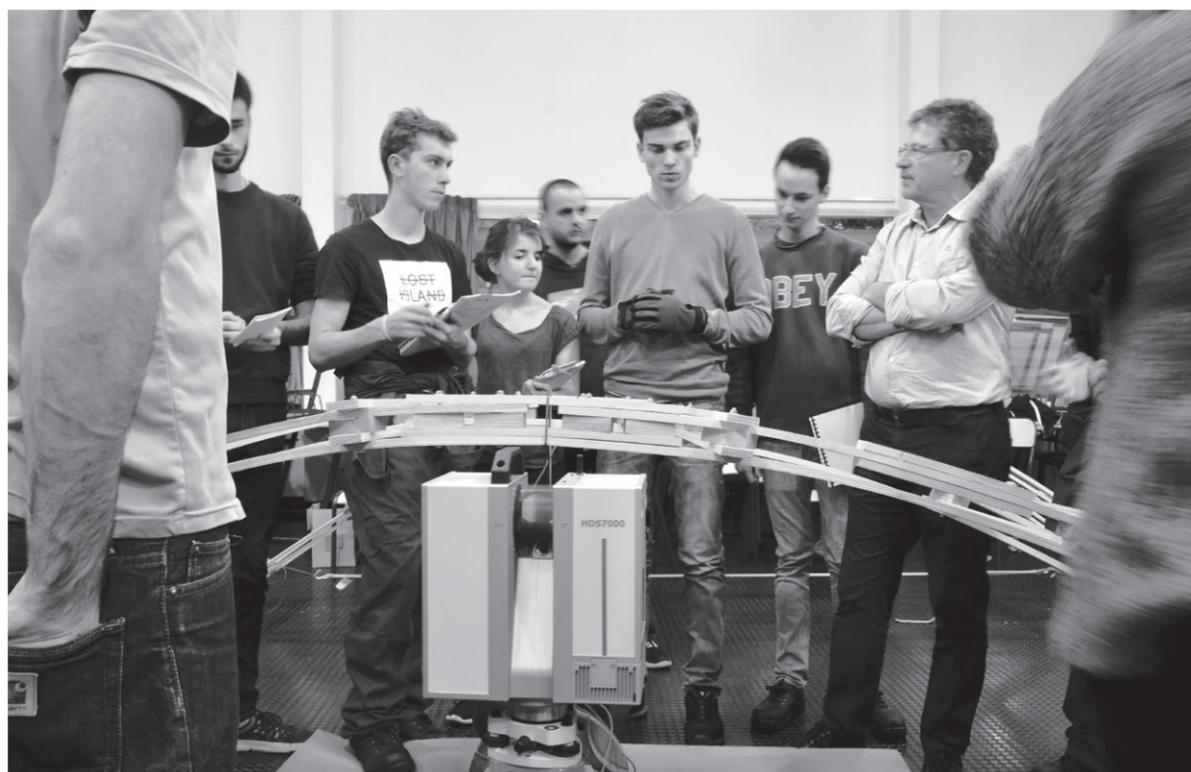
mise en oeuvre d'une arche et visualisation des déformations sous chargement avec le scanner 3D © Lionel Clot ENSA Toulouse
